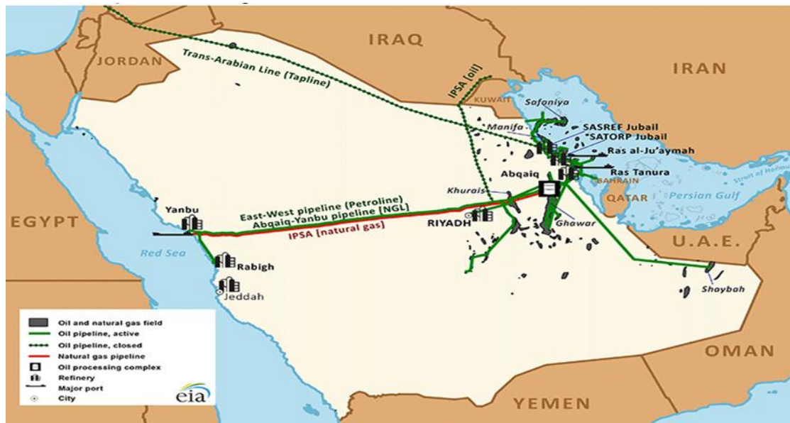
Fig. 1: Infrastructures pétrolières et gazières principales de l'Arabie Saoudite Source : Energy Information Administration (EIA) des États-Unis, HIS EDIN
